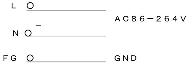
AC 86～264Vまでの電源電圧が可能です。モータ電圧に合わせた電源をご使用下さい。
